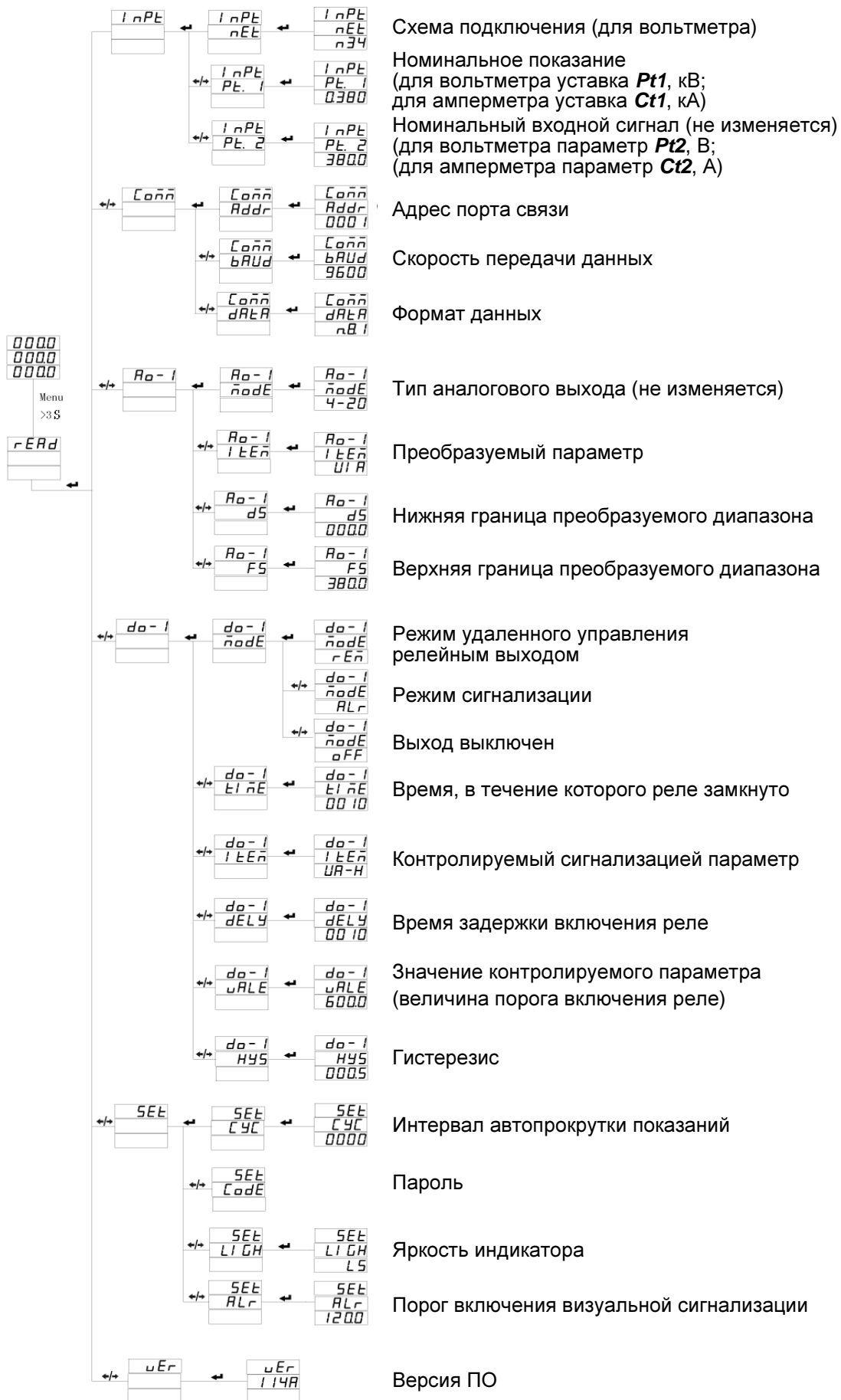
Рисунок 5.3 – Структура меню 3-канальных вольтметров и амперметров
